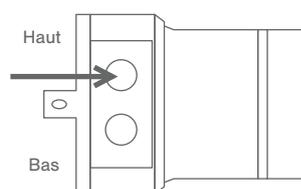
1. Tournez la vis "haut" pour régler la position de la limite d'ouverture.
