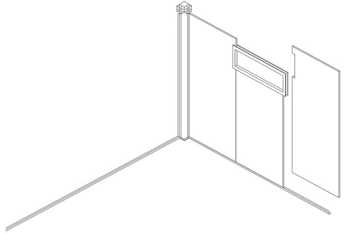
**9.** Une fois que la façade ait ses 3 panneaux en sandwich, emboîter l'embout de la fenêtre
