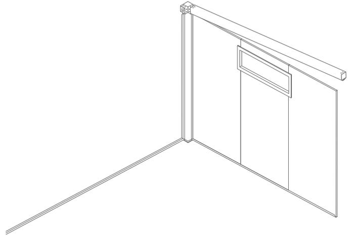
**11.** Insérez le pilier dans la poutre et vissez-les avec des vis M8x25.
