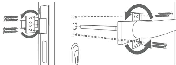
Pour placer la poignée, retirer d'abord les vis de la porte. Prenez votre poignée puis faite tourner la partie supérieure pour débloquer les ouvertures de fixations. Revisser ensuite la poignée au vantail.
