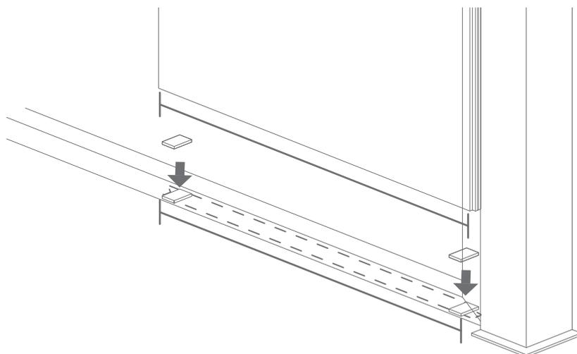
**6.** Placer le 1° panneau isolé cloison en l'emboîtant dans le pilier.
