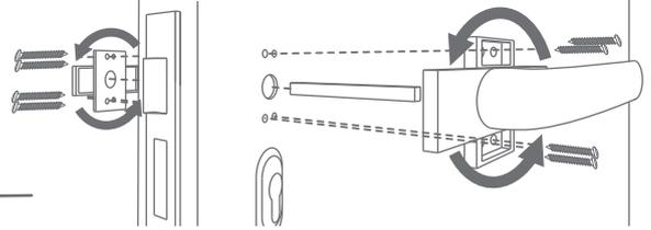
Pour placer la poignée, retirer d'abord les vis de la porte. Prenez votre poignée puis faite tourner la partie supérieure pour débloquer les ouvertures de fixations. Revisser ensuite la poignée au vantail.
