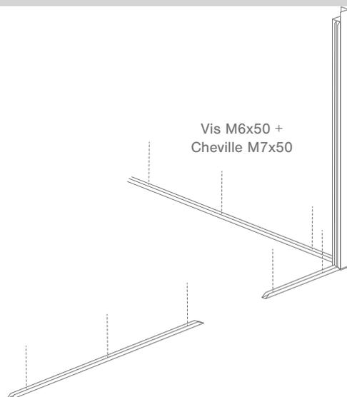
**5.** Prenez les mesures du panneau de façade et placez des cales dans les extrémités afin que le panneau ne soit pas en contact avec le sol. (Faites-le sur tous les panneaux)
