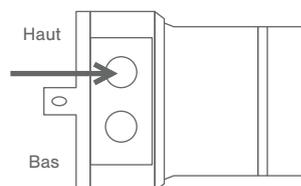
1. Tournez la vis "haut" pour régler la position de la limite d'ouverture.
