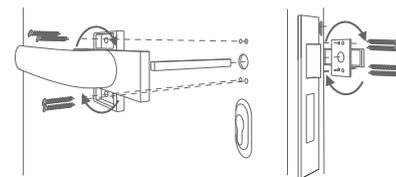
Pour placer la poignée, retirer d'abord les vis de la porte. Prenez votre poignée puis faite tourner la partie supérieure pour débloquer les ouvertures de fixations. Revisser ensuite la poignée au vantail.
