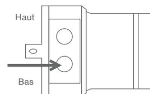
2. Tournez la vis "bas" pour régler la position de la limite de fermeture.
