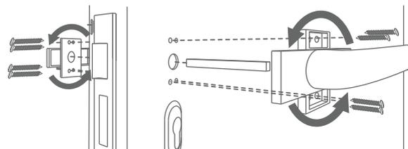
Pour placer la poignée, retirer d'abord les vis de la porte. Prenez votre poignée puis faites tourner la partie supérieure pour débloquer les ouvertures de fixation. Revisserez ensuite la poignée au vantail.
