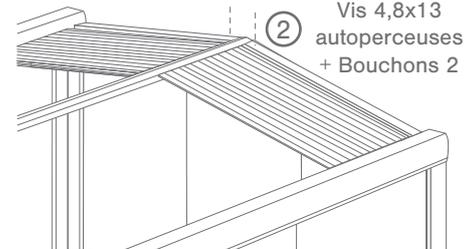
2. Fixez la plaque au centre du profil en U avec des vis auto-perceuses 4,8x13 et des bouchons 2.
