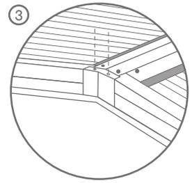
3. Fixer avec des vis autoperceuses 4,8x19.
