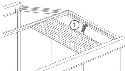
1. Insérez la plaque de polycarbonate dans la rainure du profil en U.
