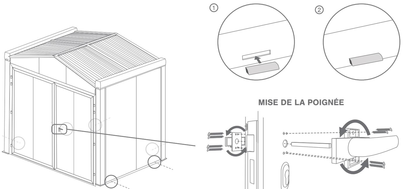
Pour installer la poignée, retirez d'abord les vis de la porte. Prenez la poignée puis tournez le haut pour déverrouiller les ouvertures de fixation. Vissez ensuite la poignée sur le battant de porte.
